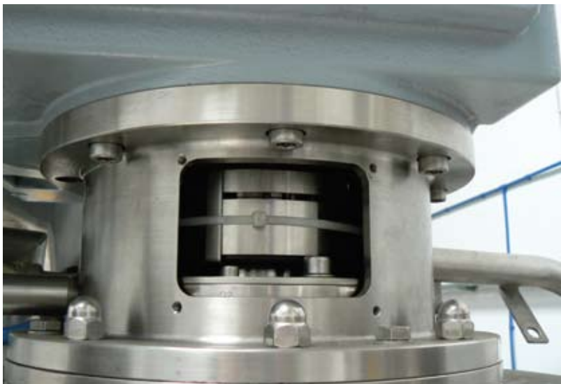
Uszczelnienie mechaniczne wału mieszadła mieszalnika z zabudową
