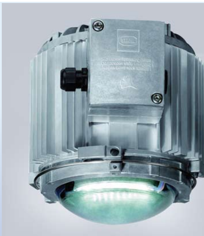
Oprawa serii 6050. Parametry: Ex d IIC T4/T6, zakres 110–240 V AC, pobór mocy poniżej 72 W, strumień świetlny powyżej 5700 lm, zakres temperatury od -40°C do +55°C, IP66/67, żywotność 50 000 godzin przy T_a < 50^\circ\text{C}
