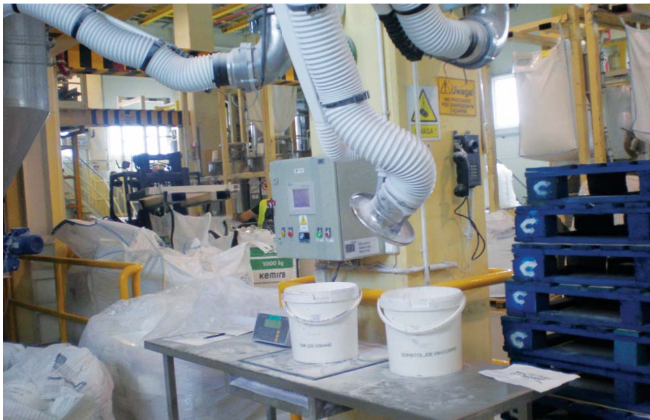
Stanowisko ręcznego naważania proszków
