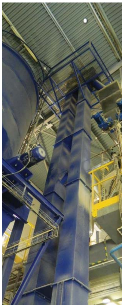
Podajnik kubelkowy trocin przed i po modernizacji
