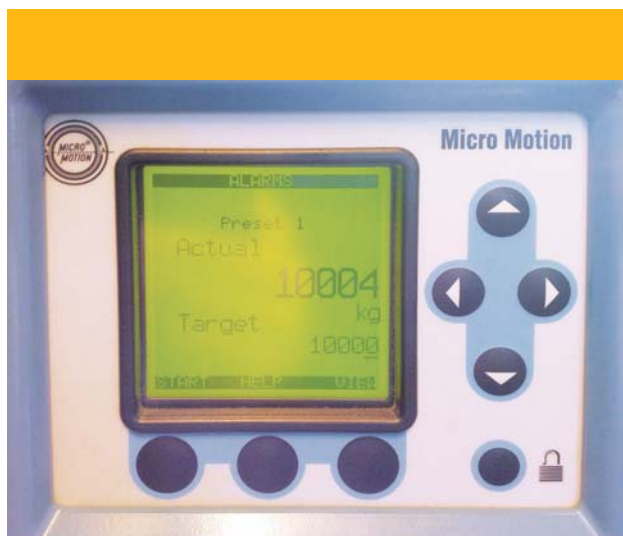
Dozownik 3700 – pierwszy rozruch systemu (wartość zadana 10.000 kg, wartość odmierzona 10.004 kg)
