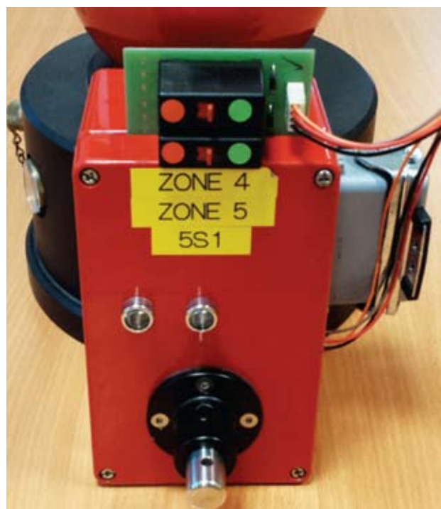
Przełącznik testowy podłączony do butli tłumienia wybuchów
