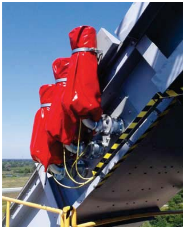
Butle tłumienia wybuchów na instalacji biomasy
