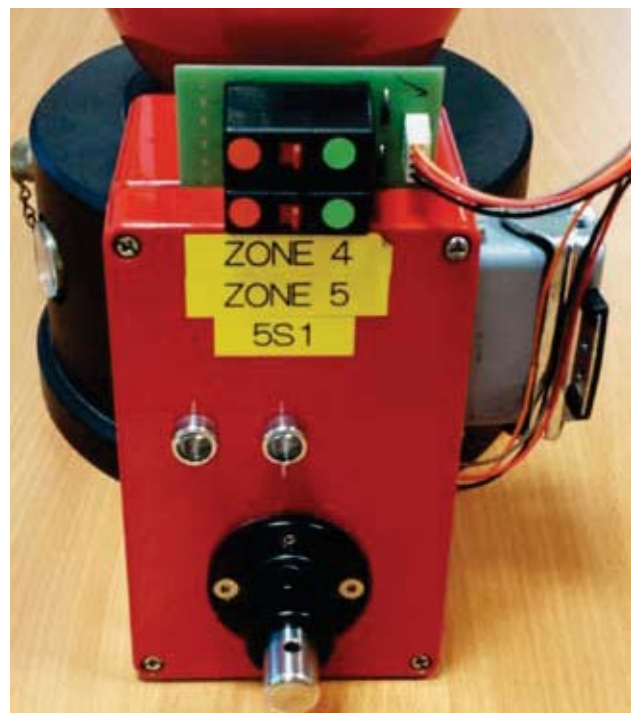
Przełącznik testowy podłączony do butli tłumienia wybuchów
